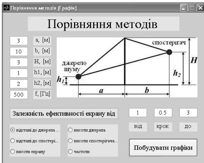
Рис. 4. Підсистема визначення ефективності шумозахисних бар'єрів різними методами в залежності від зміни одного з параметрів
