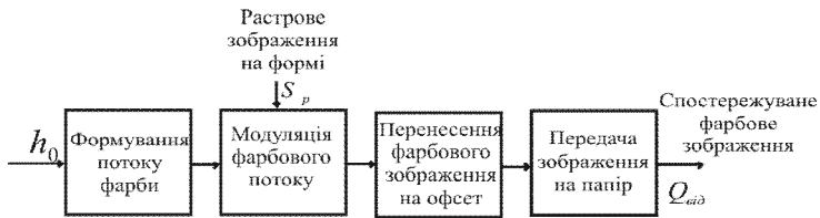
Рис. 1. Загальна функціональна схема відтворення растрового зображення фарбодрукарською системою
