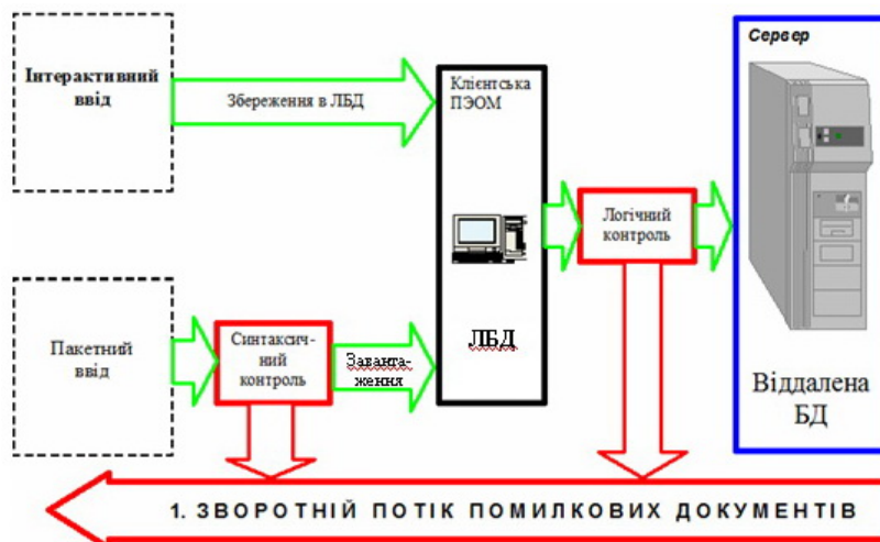
Рис. 3. Технологія обробки інформації в інформаційних підсистемах ОВС. (БД – база даних; ЛБД – локальна база даних)
