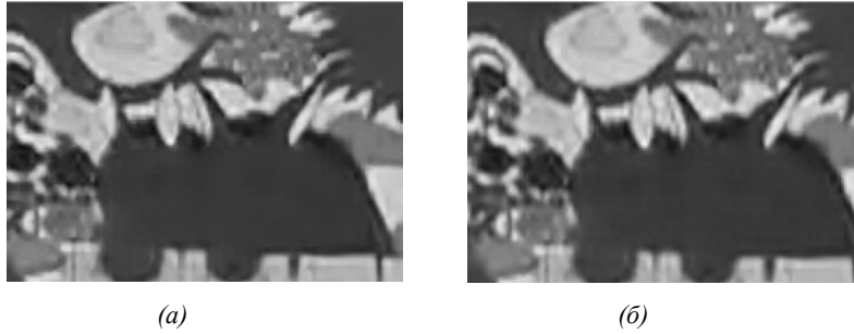
Рис.2. Кадри інтерпольованої послідовності Mobile and Calendar з використанням коефіцієнтів фільтра оптимізованих відносно а) метрики MSE ( MSE = 616.46 , SSIM = 0.642 ) б) метрики SSIM ( MSE = 635.31 , SSIM = 0.661 ).
