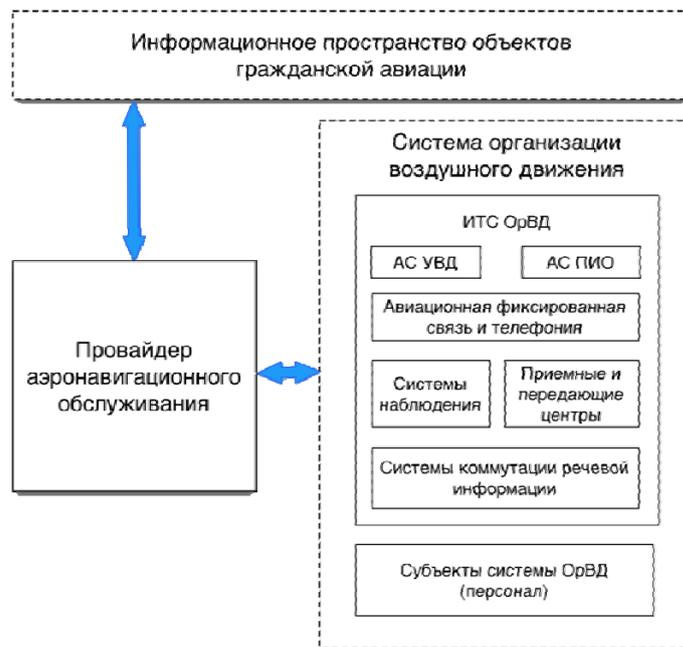
Рис. 2. Компоненты системы ОрВД
