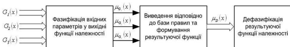
Рис.1. Загальна структура нечіткої моделі багатокритеріальної оптимізації вибору базової малохвильової функції на основі методу Мамдані
