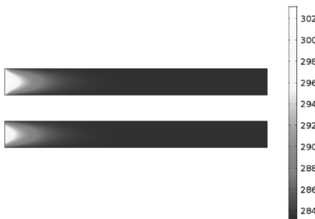
Рис. 3 Температурне поле в каналі при використанні граничної умови температура (вгорі) і вхідний потік (внизу) при L = 0 і U_{in} = 10 \text{ см/с} .
