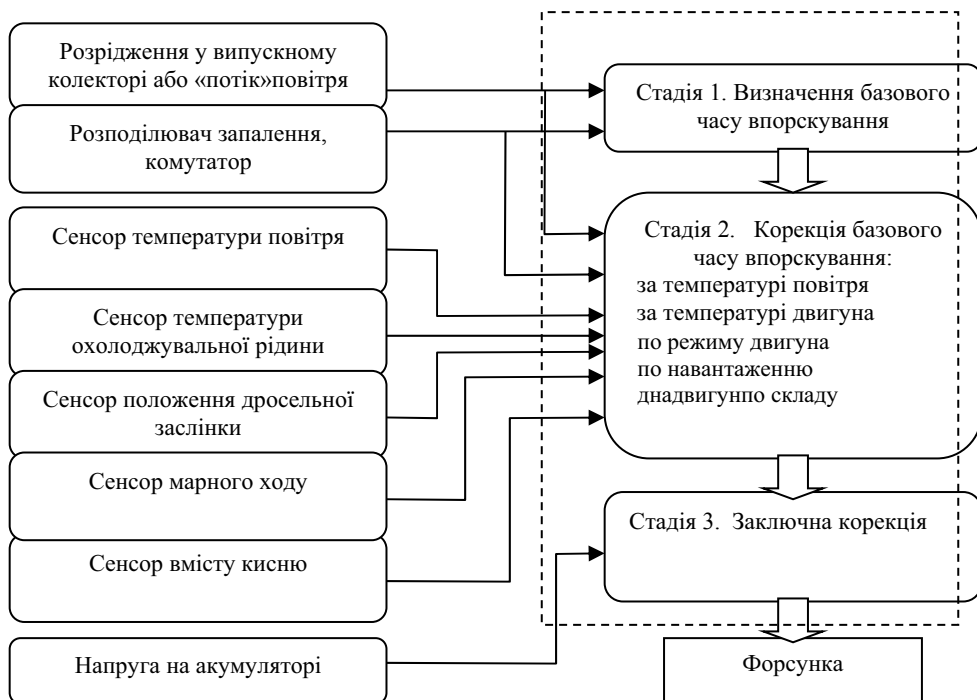
Рис. 1. Алгоритм розрахунку часу впорскування
